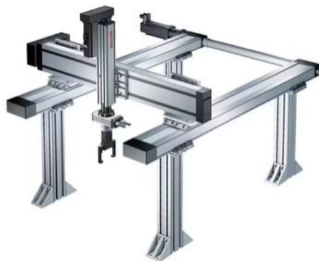
Robot tuyến tính Cartesian robot
