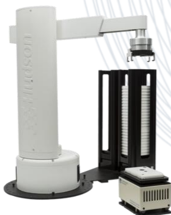
Robot hình trụ Cylindrical Robots
